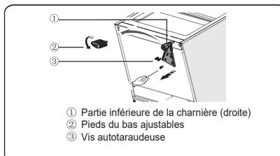
11. Remplacez la partie inférieure de la charnière sur le côté gauche et la fixez à l'aide des vis autotaraudeuses spéciales de la bride. Remplacez les parties inférieures des pieds réglables d'un autre côté et fixez-les.
