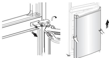
8. Placez la porte inférieure sur une surface lisse avec son panneau vers le haut. Desserrez la vis ② et la pièce ①, puis installez-les sur le côté gauche et serrez-les fermement.
