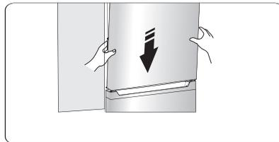
15. Transférez la partie supérieure de la charnière et faites rentrer l'axe de la charnière supérieure dans le trou supérieur de la porte supérieure, et ajustez la position de la porte supérieure (veuillez soutenir la porte supérieure avec la main), en fixant la partie supérieure de la charnière avec les vis autotaraudeuses spéciales à bride.
