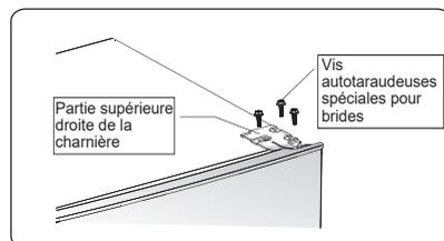
4. Retirez l'axe supérieur de la charnière, transférez-le sur le côté renversé et serrez-le fermement, puis placez-le dans un endroit sûr.
