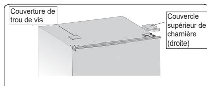
3. Dévisser les vis autotaraudeuses spéciales de la bride qui servent à fixer la partie supérieure droite de la charnière à l'aide d'un tournevis à douille de 8 mm ou d'une clé (en le faisant, veuillez soutenir la porte supérieure avec votre main).
